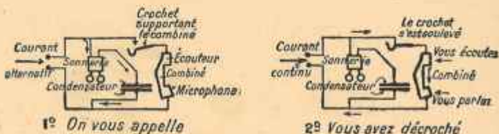
FIG. 162. — Montage et fonctionnement du poste d'abonné.
